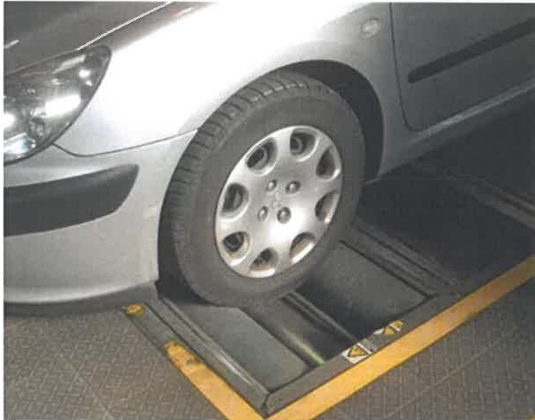
Slika 15. Valjci za ispitivanje kočnica na vozilu
