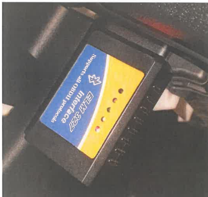
Slika 19. Priključeni OBD uređaj na vozilo
