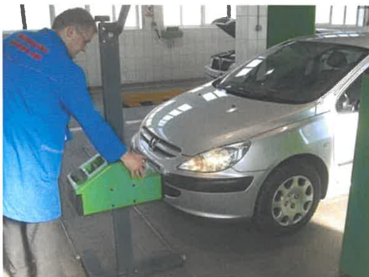
Slika 17. Ispitivanje svjetala pomoću regloskopa
