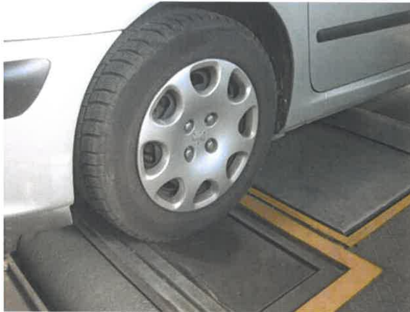
Slika 14. Ploča za testiranje stupnja prigušenija amortizera
