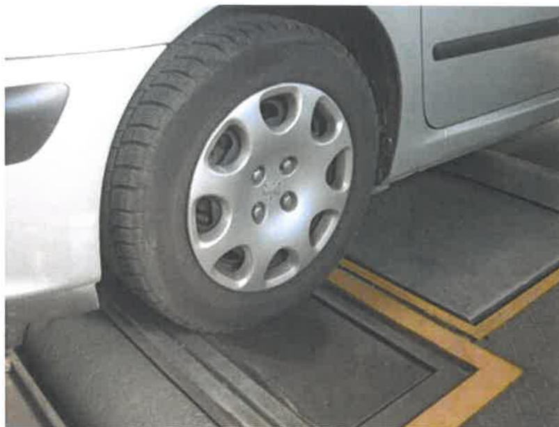
Slika 14. Ploča za testiranje stupnja prigušenija amortizera
