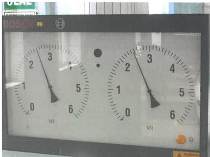
Slika 16. Analogni pokazivač kontrole kočnica
