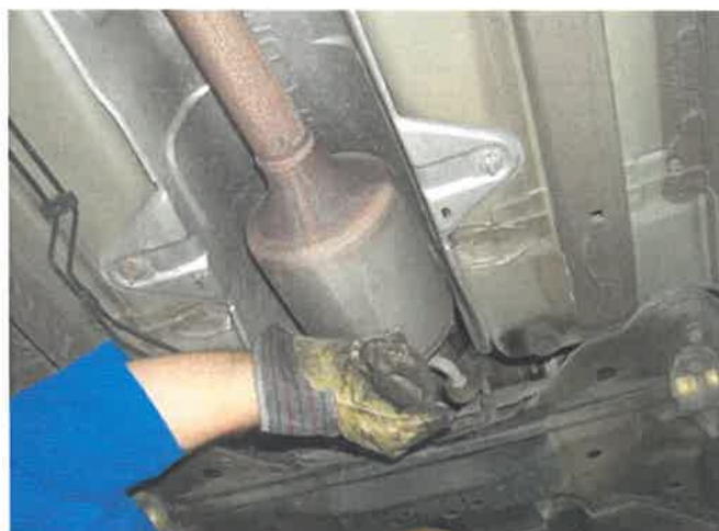
Slika 9. Udaranje rukom katalizator radi provjere njegovog stanja
