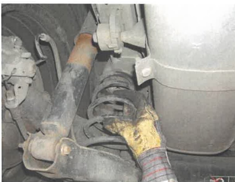
Slika 10. Provjera ispravnosti stražnje osovine i amortizera
