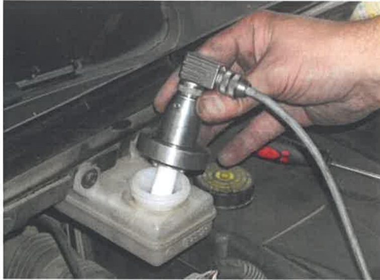
Slika 12. Mjerenje isparavanja kočne tekućine
