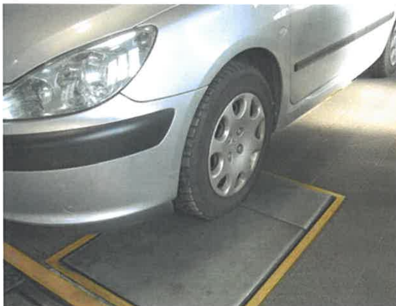
Slika 13. Provjera kontrole traga kotača
