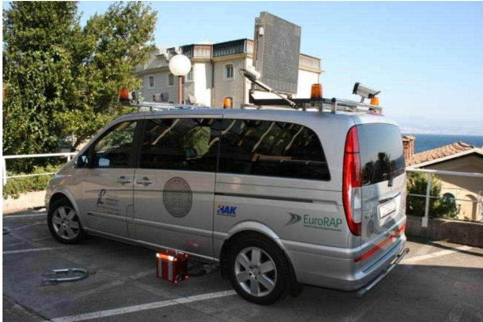
Slika 3. Vozilo za prikupljanje podataka
