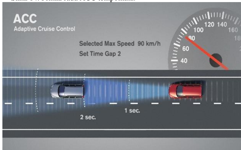
Slika 14. Prikaz rada ACC tempomata.
