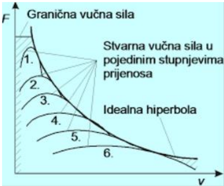
Slika 13. ovisnost vučne sile o stupnju prijenosa mjenjača.
