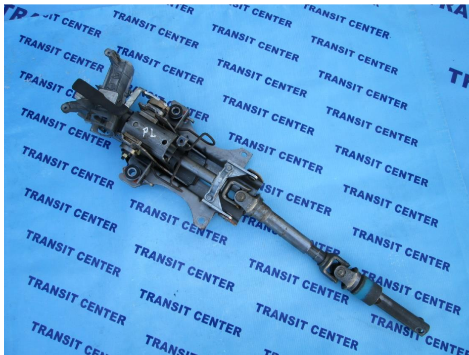
Slika 12. Zglobni stup upravljača
