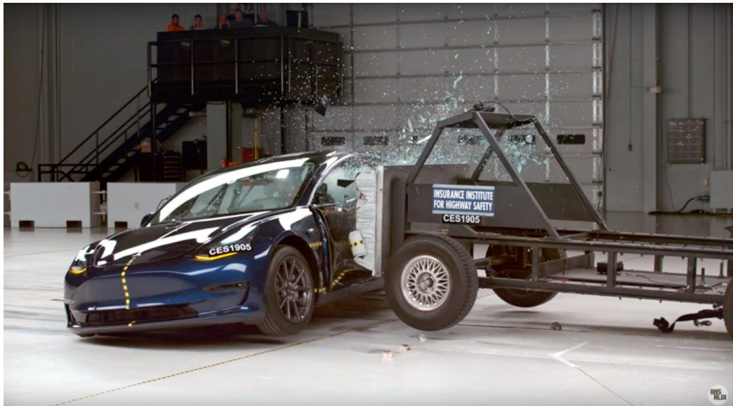
Slika 14. Izvedba ispitivanja bočnog sudara
