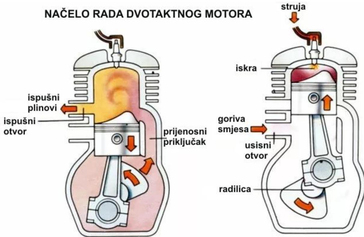
Tlak plinova izgaranja potiskuje klip prema DMT. Nakon prekrivanja ulaznog otvora, počinje pretkompresija gorive smjese na približno 0,3 do 0,8 bara. Proces izmjene plinova ispod i iznad klipova odvija se u tri faze:
