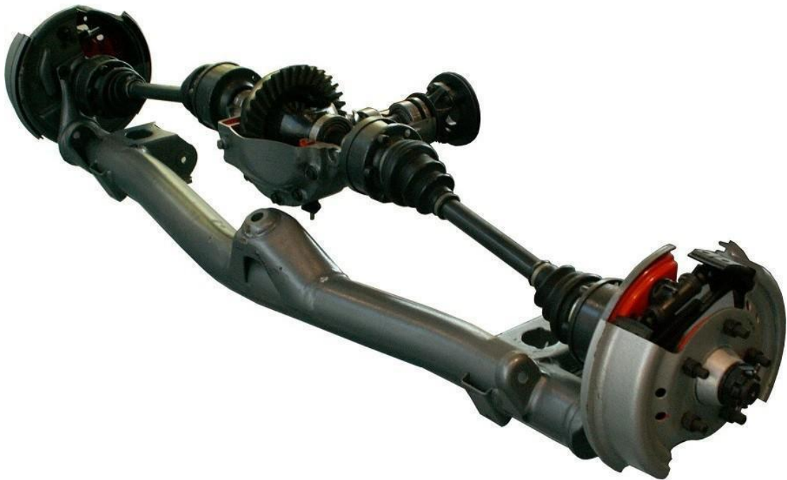
Slika 19, De Dion stražnji ovjes, Alfa rz
