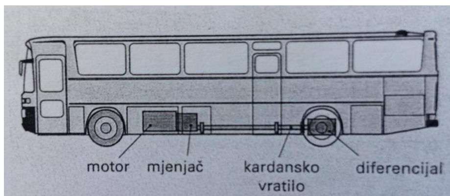
Slika 6. Motor ispod poda
