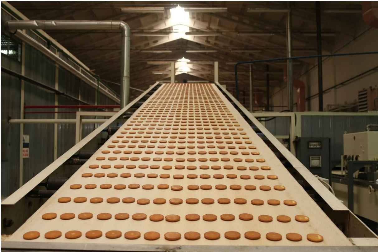
Slika 10. Trakasti transporter s gumenom trakom
