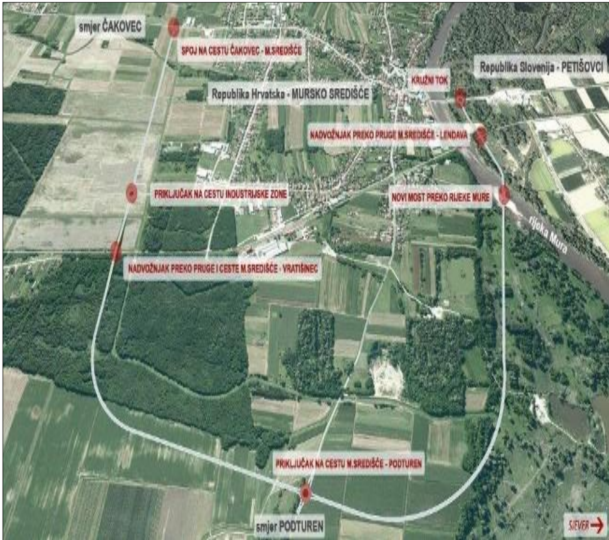
Slika 14. Idejno rješenje zaobilaznice za teretni promet
