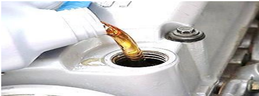
Slika br. 15 Ulijevanje ulja u mjenjač
