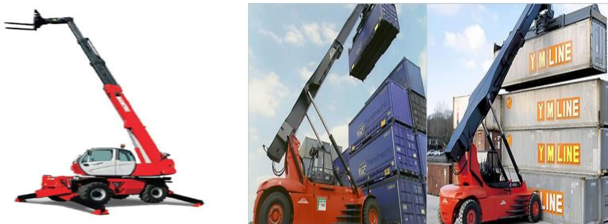
Slika 11. Teleskopski i portalni viličari
