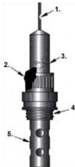
Slika 8. Djelovi lambda sonde
