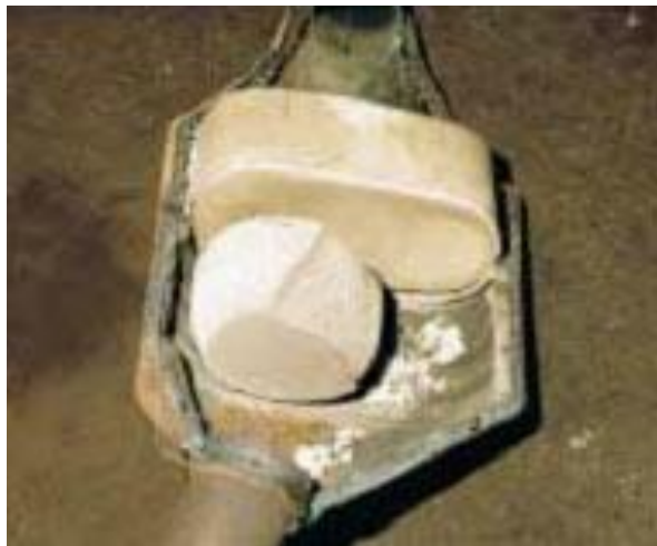
Slika 10. Fizičko oštećenje katalizatora
