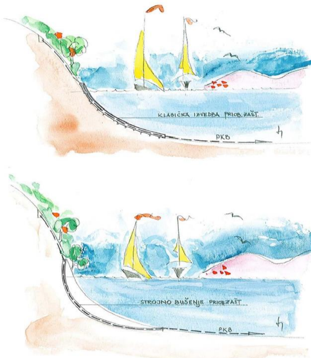
Slika 18. Klasična i strojna izvedba priobalne zaštite
