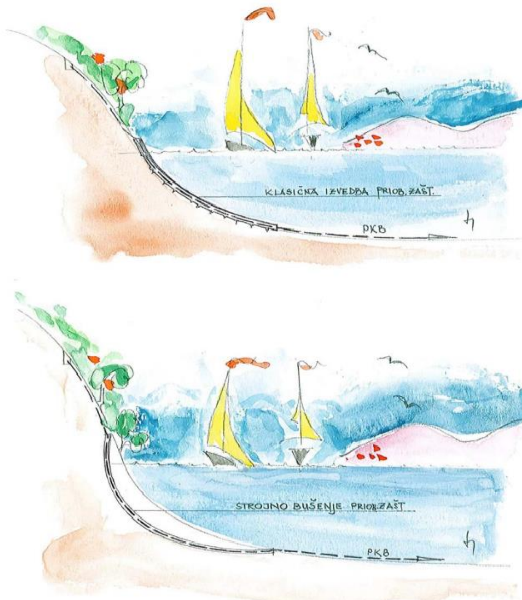
Slika 18. Klasična i strojna izvedba priobalne zaštite
