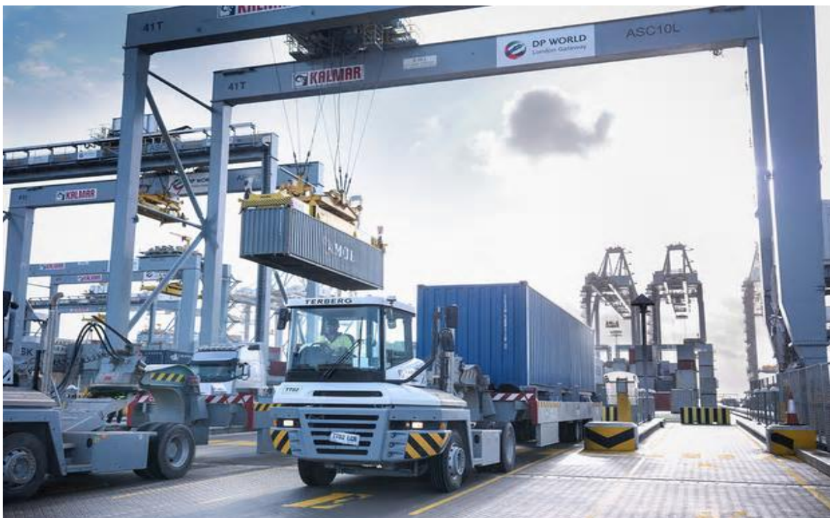
Slika 3. Tegljač za prijevoz kontejnera na terminalu
