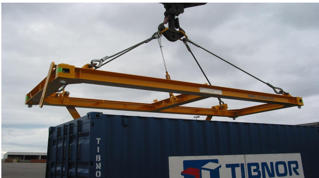
Slika 11. Hvataljke za kontejnere
