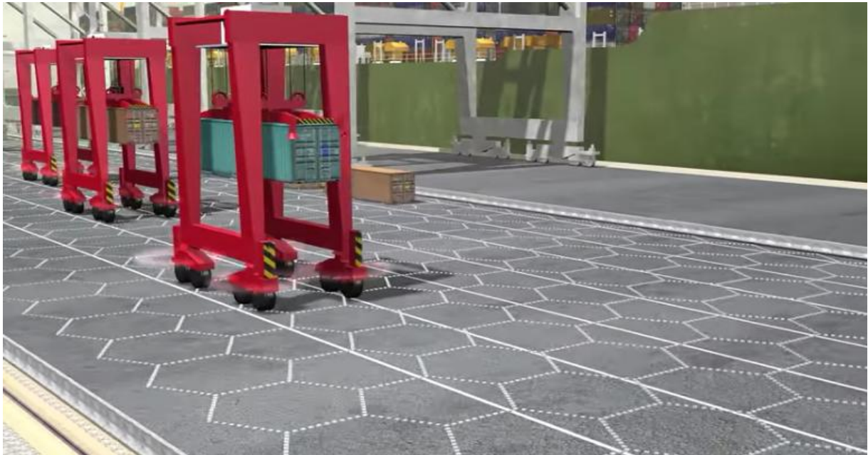
Slika 17. Prikaz magnetskih čelija za automatsko vođenje
