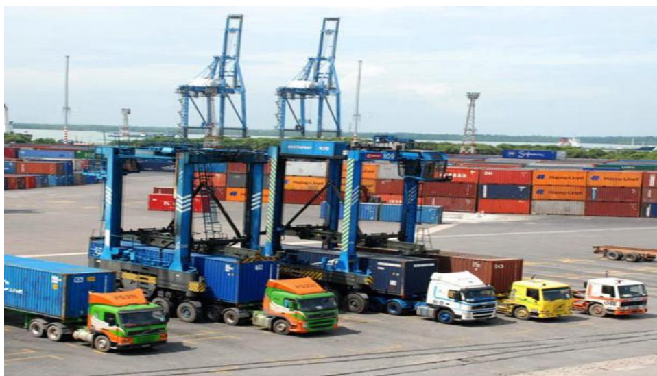
Slika 12. Portalni prijenosnik malog raspona
