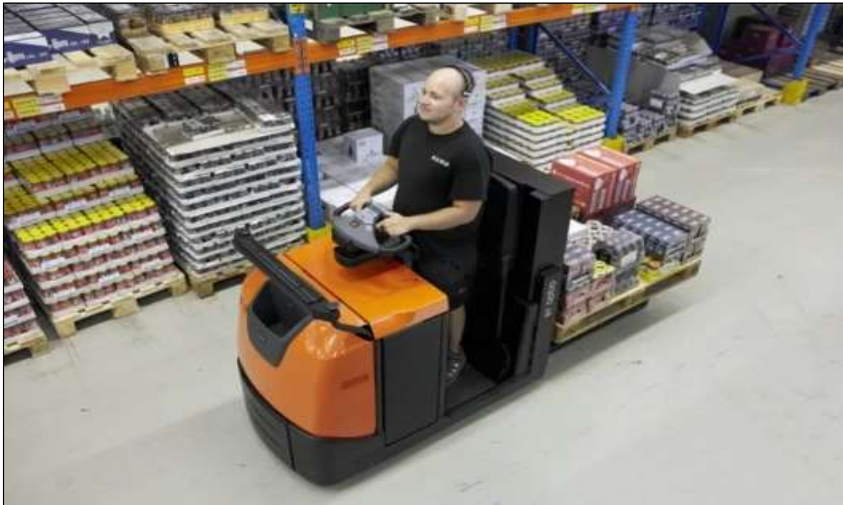
Slika 10. Prikaz primjera niskopodnog viličara za komisioniranje robe.
