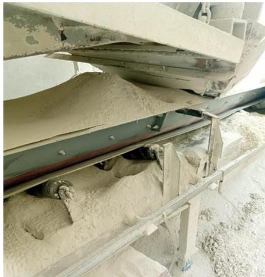
*Slika 23. Trakasti transporter koji prenosi vapno*
