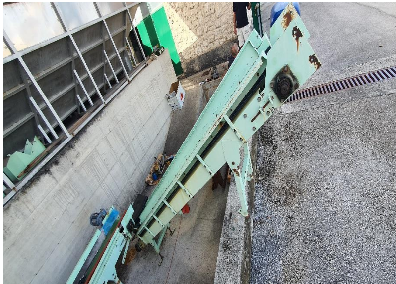
Slika 25. Kosi trakasti transporter s ravnom gumenom trakom
