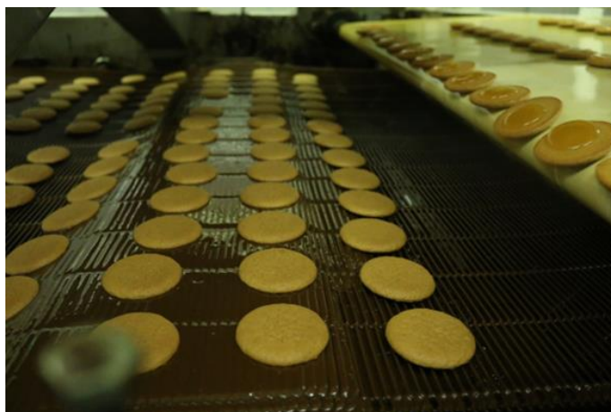
Slika 29. Trakasti transporter s žičanom trakom
