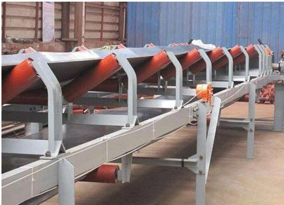
*Slika 9. Valjci za usmjerivanje i nošenje trake*
