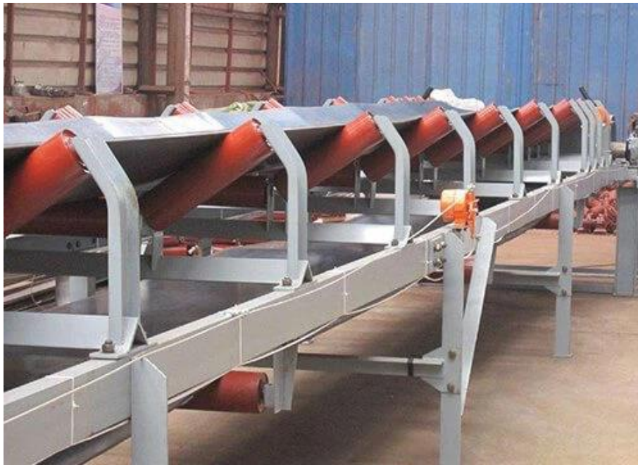
Slika 9. Valjci za usmjerivanje i nošenje trake
