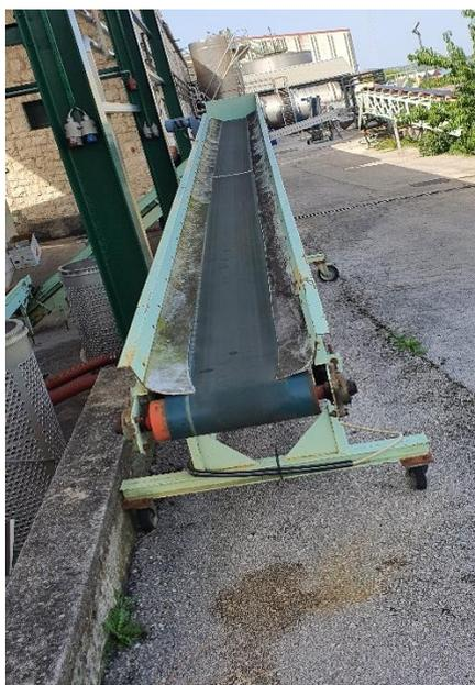
*Slika 26. Kosi mobilni traksti transporter s ravom gumenom trakom*
