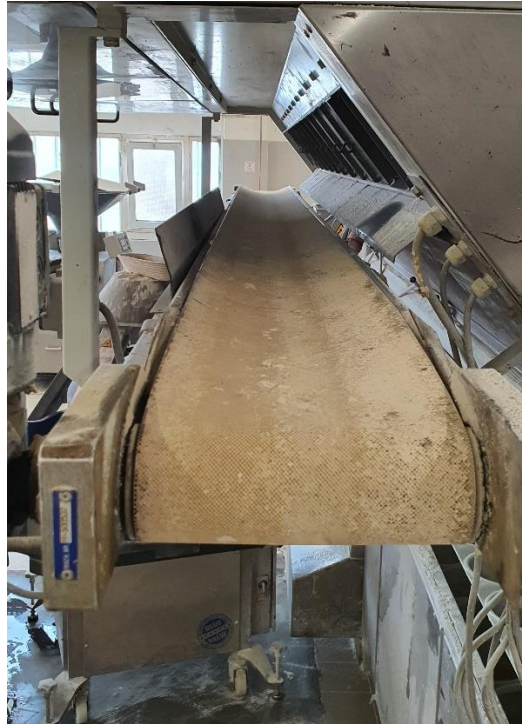
Slika 32. Trakasti transporter s platnom trakom
