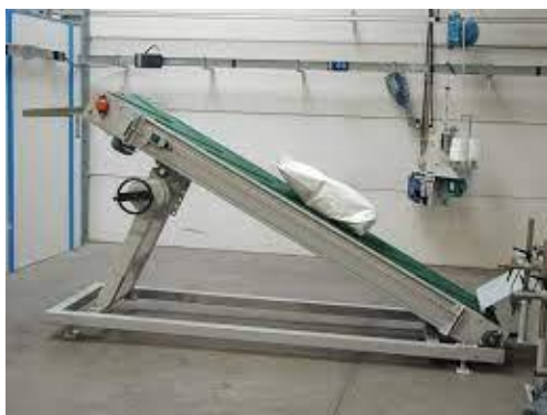
Slika 4. Trakasti transporter pod nagibom
