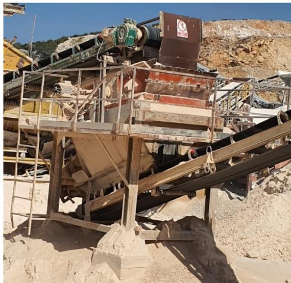
*Slika 17.* Drobilica za kamen s dva trakasta transportera s gumenom trakom
