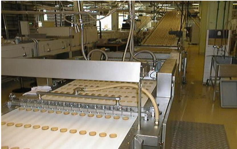
*Slika 28.* Trakasti transporter s čeličnom trakom
