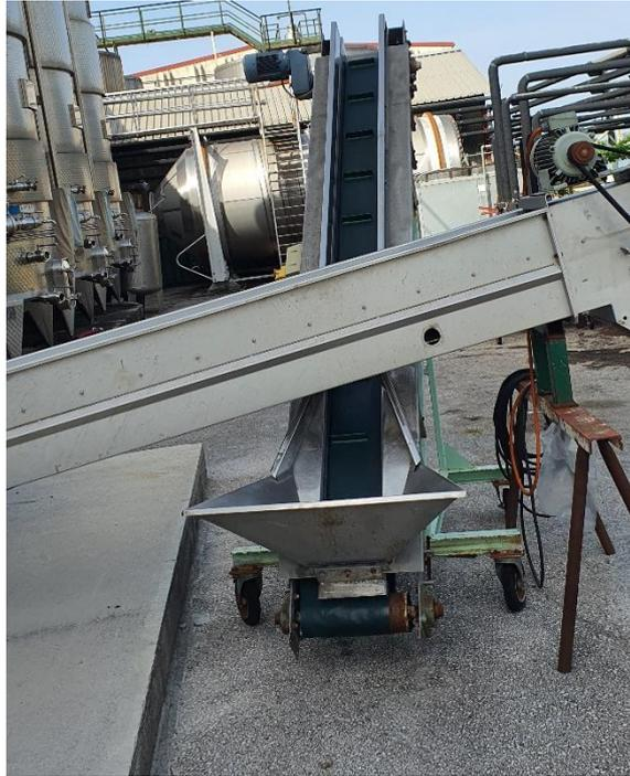
*Slika 24. Kosi trakasti transporter s gumenom rebrastom trakom*
