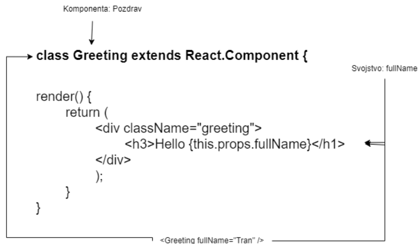
Slika 7: React.js props primjer
