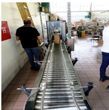
Slika 23. Horizontalni valjkasti transporter
