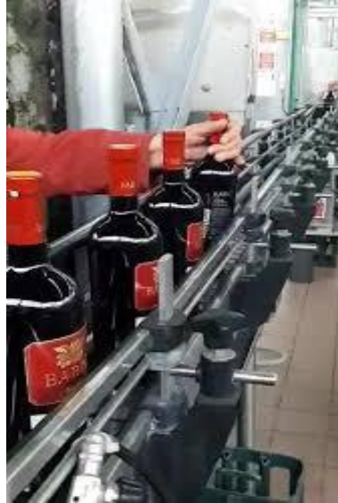
Slika 20. Proizvodna linija s trakastim transporterom,
