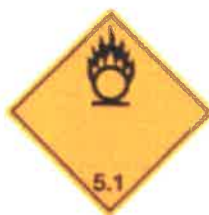
Slika 8. Listice oksidirajućih tvari, Izvor: Pravilnik o međunarodnom prijevozu opasnih tvari željeznicom – RID 2019.
