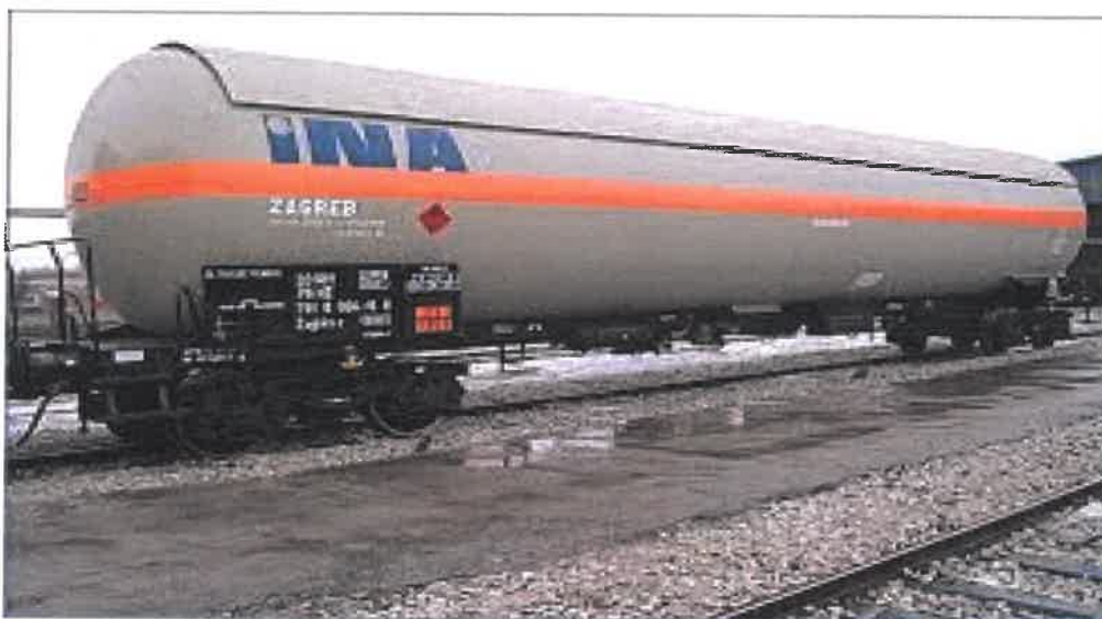
Slika 15. Plinski vagon cisterni serije Zagks-z, Izvor: Osobna izrada autora
