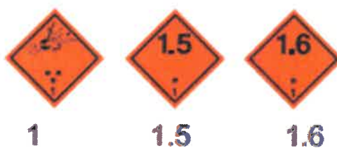
Slika 2. Listice eksplozivnih tvari i predmeta, Izvor: Pravilnik o međunarodnom prijevozu opasnih tvari željeznicom – RID 2019
