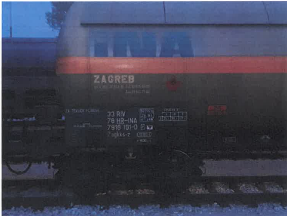
Slika 17. Primjer označavanja transporta opasnih tvari na vagonu, Izvor: Osobna izrada autora
