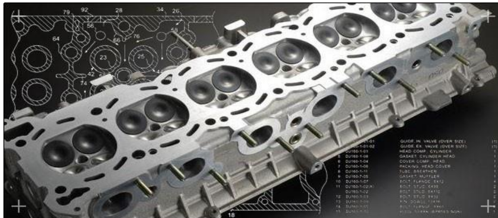
Slika 4. Glava diesel motora, Izvor: https://www.autonet.hr
