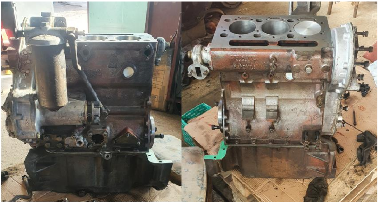
Slika 11. Blok diesel motora, Izvor:autor
