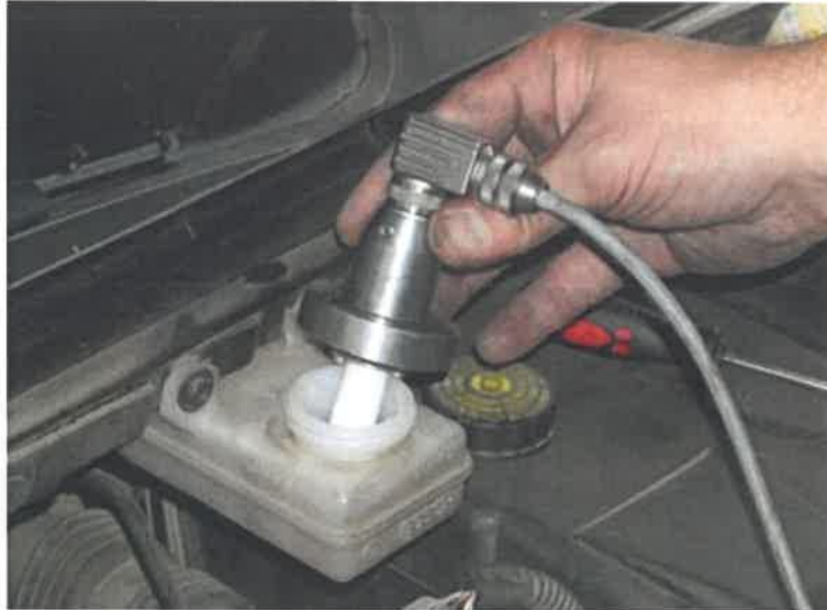
Slika 12. Mjerenje isparavanja kočne tekućine
