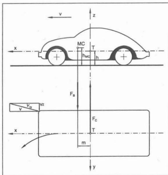
*Slika 10. Prikaz sile djelovanja bočnog vjetrana vozilo boljeg aerodinamičkog oblika,*
