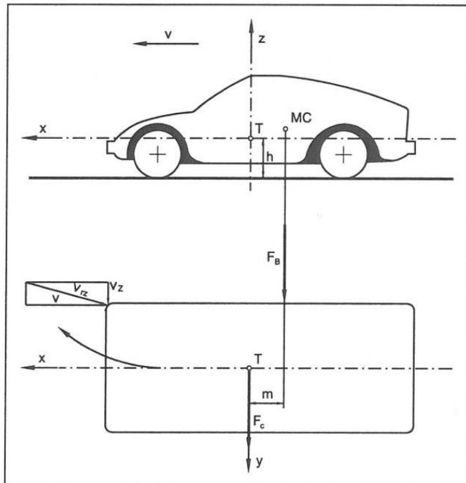
Slika 11. Prikaz sile djelovanja bočnog vjetrana vozilo bolje nepovoljnijeg aerodinamičkog oblika,
