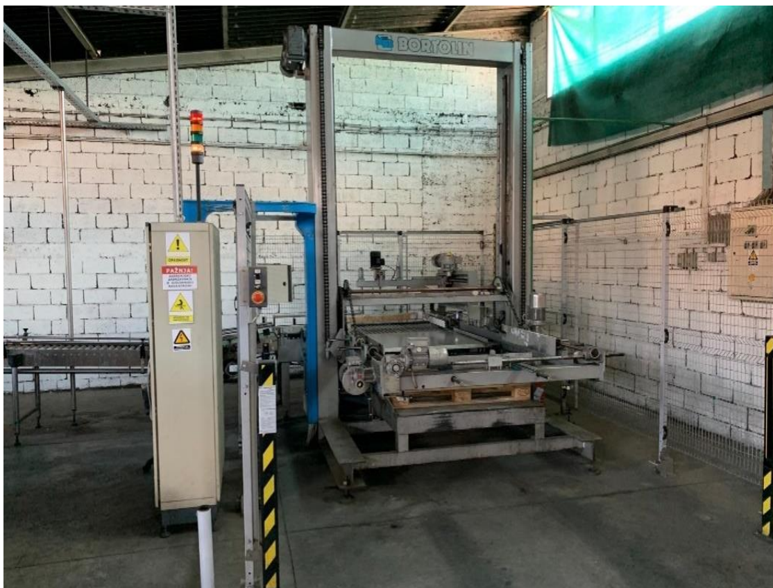
Slika 21. Paletizator u skladištu vinarije, Izvor: vlastita izrada autora
