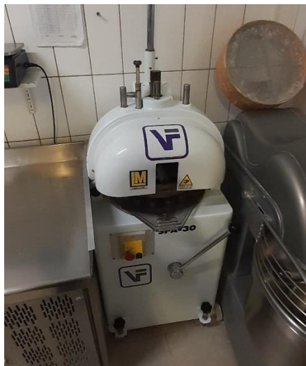
Slika 21 Preša za rezanje peciva
