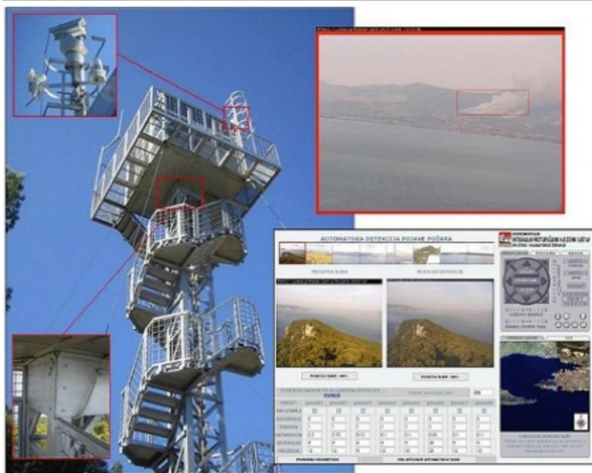
Slika 14. Motrilačka jedinica i korisničko sučelje eksperimentalne verzije sustava IPNAS postavljene na brdu Marjan u Splitu 2005.godine.
