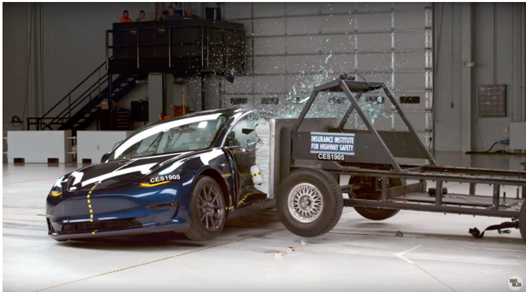
Slika 14. Izvedba ispitivanja bočnog sudara
