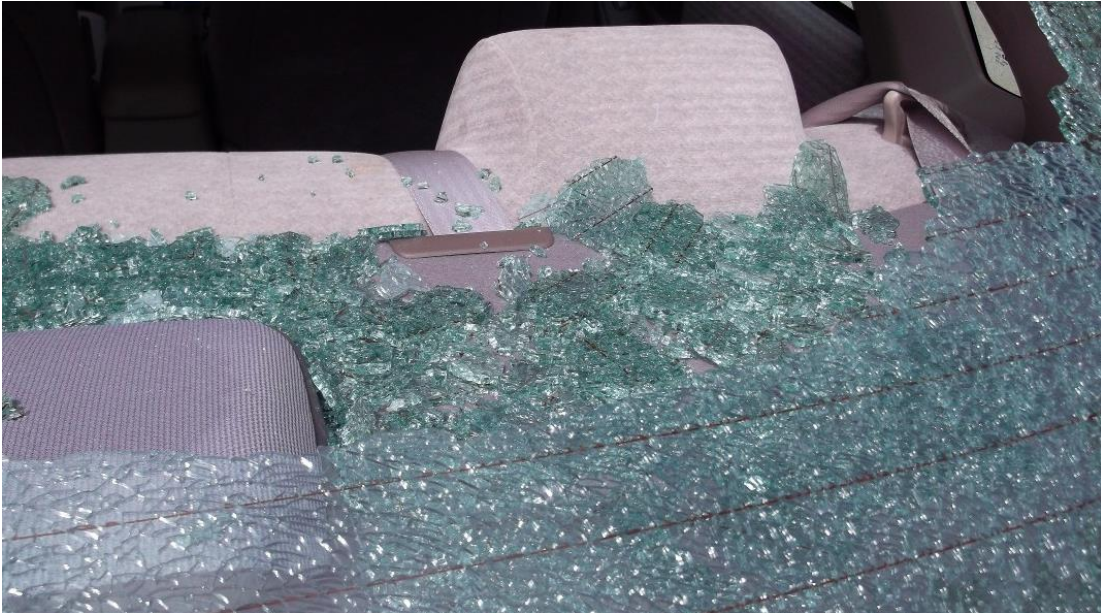
Slika 11. Puknuće jednoslojnog stakla
