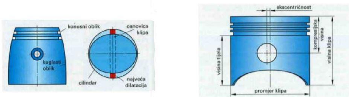
Slika 2: Oblik klipa u hladnom stanju (lijevo) i oblik klipa na radnoj temperaturi (desno)
