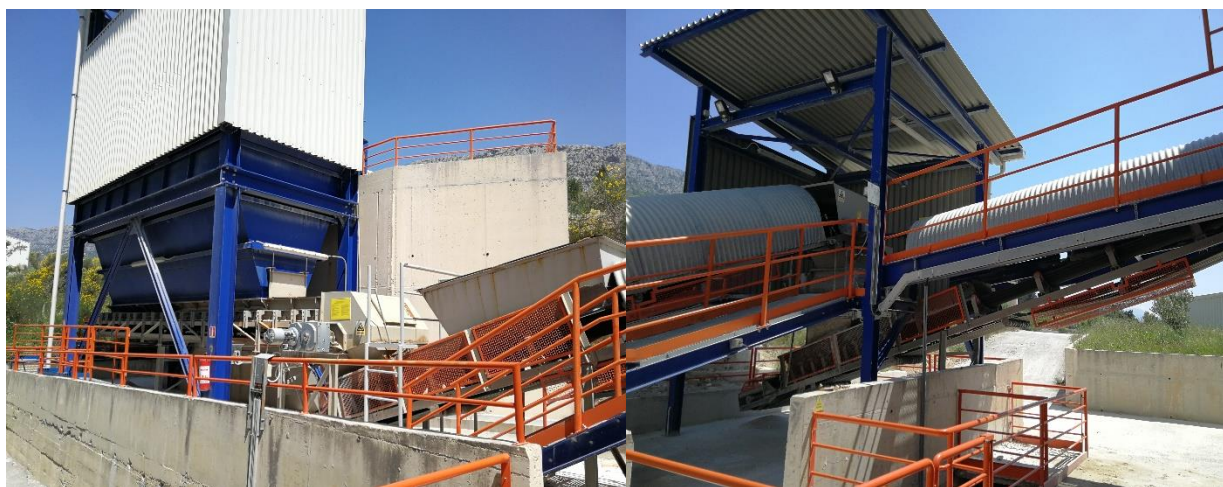
Slika 27. Fluorspar spremnik (lijevo), pokretna traka koja vodi put hangara (desno) i automatizirana vaga na mjestu sastajanja dviju traka (dolje)
